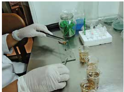
Figura 20. Esterilización superficial de raíces u otros tejidos.
